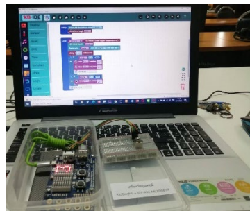
เขียนโปรแกรมสร้างเครื่องวัดอุณหภูมิร่างกาย
